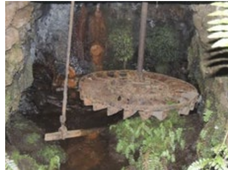
Fig.4 Rodicio coa súa maquinaria perfectamente conservada e con pouca ferruxe
